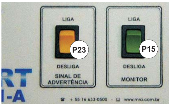
FIGURA 3.9 - FOTO PARCIAL DO PAINEL DO ALERT MOSTRANDO AS CHAVES COLORIDAS TIPO TECLA LIGA/DESLIFA: - chave verde, liga o monitor - chave amarela, liga o sinal de advertência.
