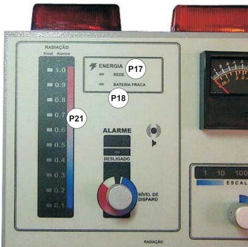
FIGURA 3.10 - FOTO PARCIAL DO PAINEL DO ALERT MOSTRANDO EM DESTAQUE O SELETOR E O PAINEL DE ALARME E (ACIMA) OS INDICADORES DE ESTADO DA BATERIA E ALIMENTAÇÃO PELA REDE.
