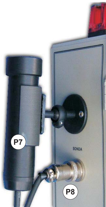
FIGURA 3.7 - FOTO DO ALERT MOSTRANDO A SONDA ENCAIXADA NO SUPORTE E O CABO CONECTADO À UNIDADE.
